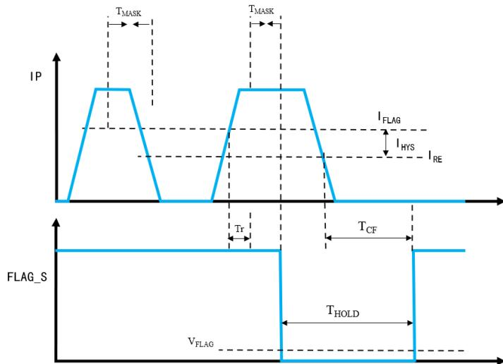
图 3: Tmask 功能启用时 FLAG\_S 时序图
