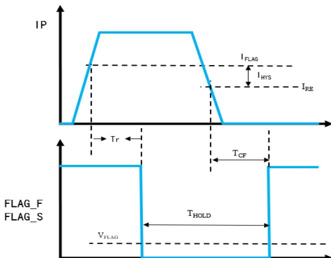
图 2: Tmask 功能禁用时的故障响应时序
